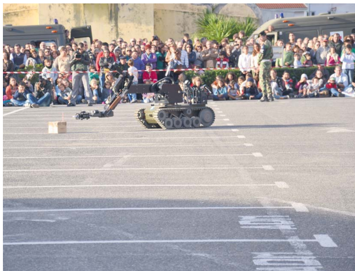
■ A utilização do robot permite manter a integridade física do militar quando é necessário destruir uma carga explosiva
