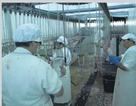
■ Nesta linha de fabrico uma dezena de operárias processa, isto é, abate, depena, prepara e embala, entre 3.500 a 4.000 aves por hora
