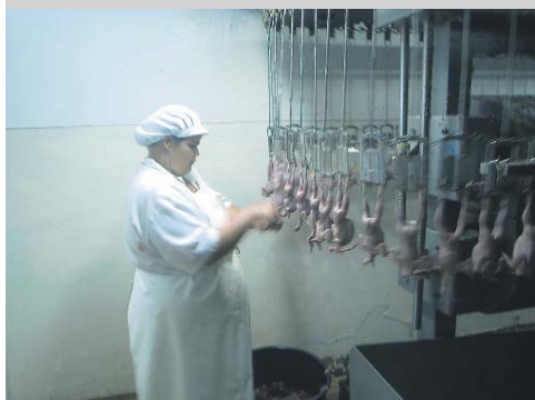
■ Nesta linha de fabrico uma dezena de operárias processa, isto é, abate, depena, prepara e embala, entre 3.500 a 4.000 aves por hora
