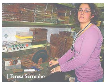
| Nesta máquina o chocolate em "pastilhas" é derretido para dar origem aos vários produtos da Bombondrice
