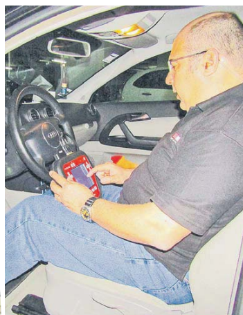
A programação das chaves automóveis é feita com uma máquina específica
